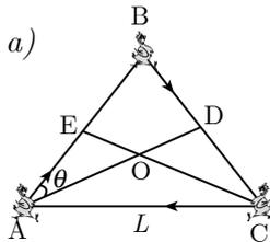
**Jawab:** Coba Anda pikirkan bahwa ketiga titik ini akan bertemu di titik berat segitiga (titik O). Lintasan titik berbentuk kurva. Untuk menghitung waktu yang ditempuh titik kita cukup menghitung jarak AO lalu membaginya dengan komponen kecepatan arah AO. (Perhatikan bahwa komponen kecepatan arah AO selalu sama di setiap titik lintasan)
